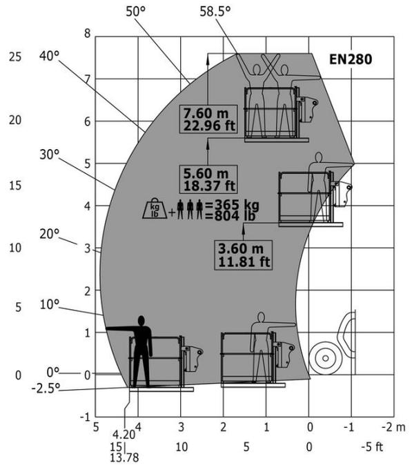
Диаграмма нагрузки, метрическая система мер
