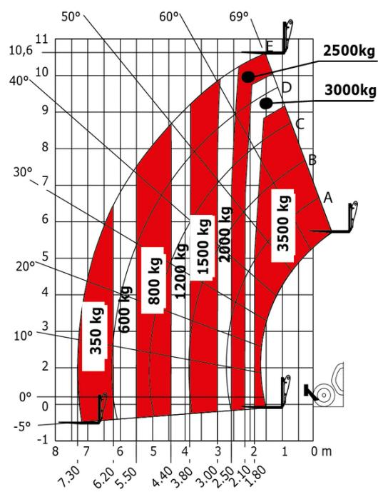
Máquina sobre estabilizadores rebaixados com garfos Metric
