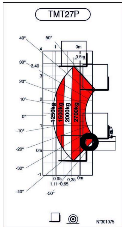
Maschine auf Rädern mit Gabelzinken LC 1200 mm
