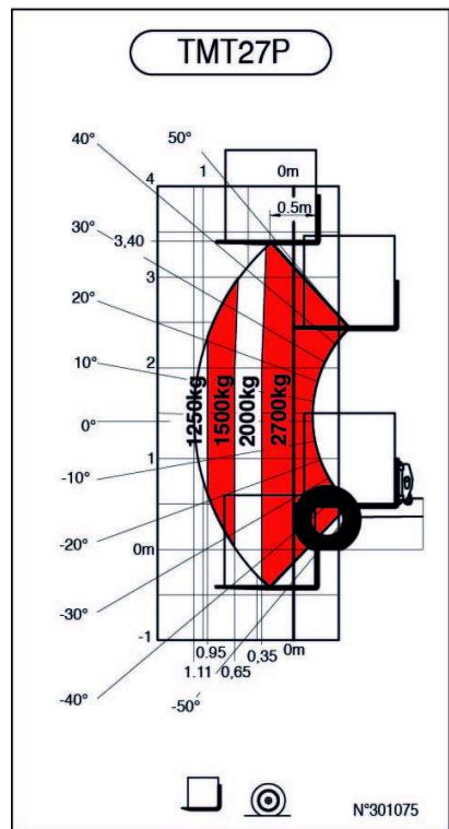
Máquina sobre neumáticos con horquillas LC 1200 mm
