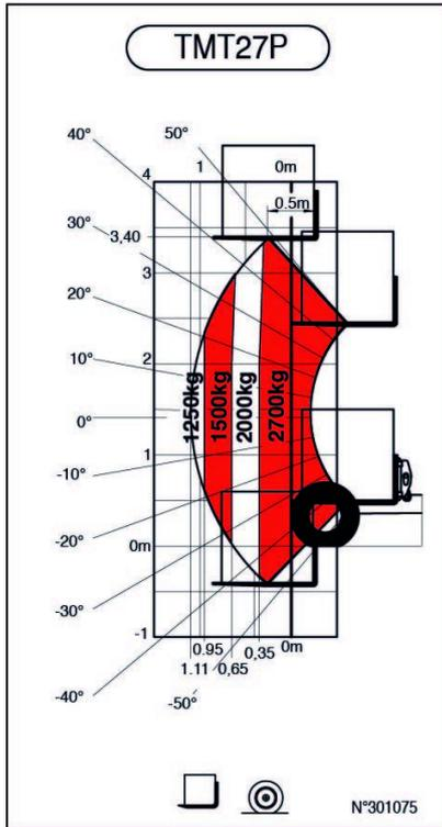
Máquina sobre neumáticos con horquillas LC 1200 mm
