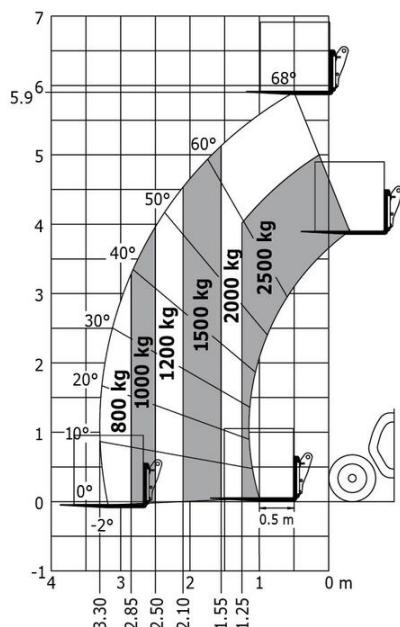
Máquina sobre neumáticos con horquillas LC 600 mm
