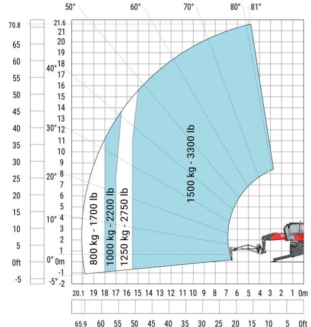
Macchina su stabilizzatori abbassati con braccio estensibile con verricello (metrico)
