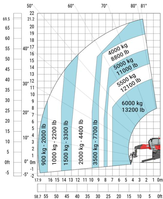
Machine sur stabilisateurs abaissés avec potence-treuil de 1500 kg (Métrique)
