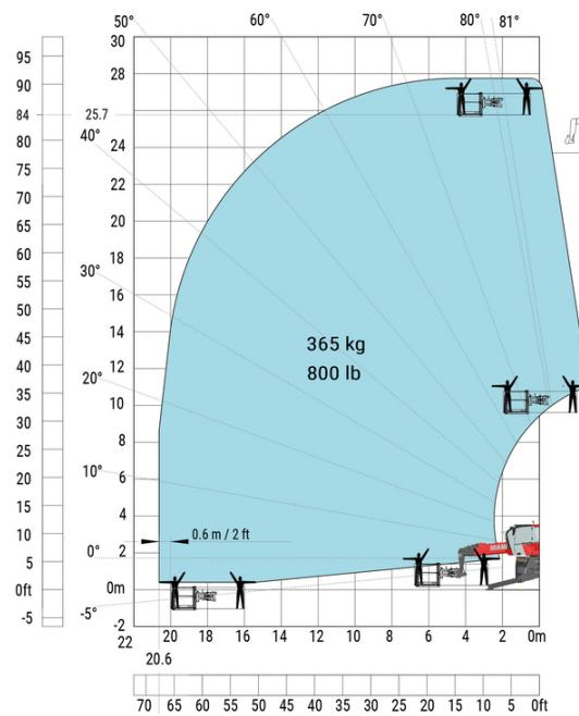
Drehung auf abgesenkten Stützen mit 1000 kg-Plattform
