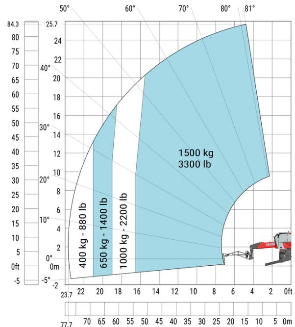
**Maschine auf abgesenkten Stabilisatoren mit ausfahrbarem Windenarm (Metrisch)**
