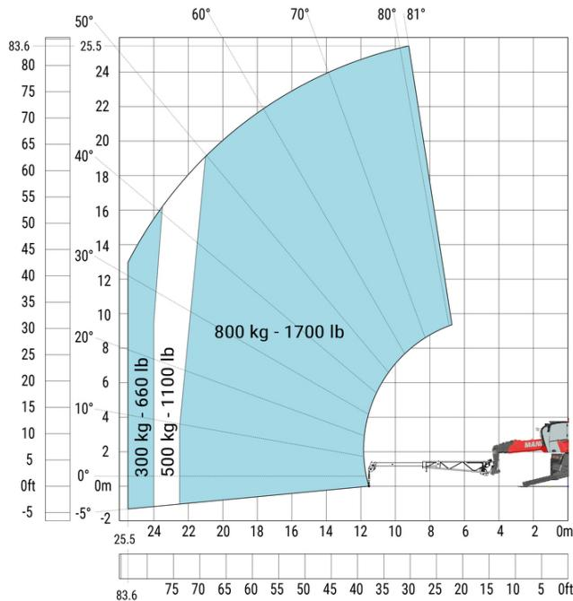
Máquina sobre estabilizadores bajados con gancho 6000 kg (Métrico)
