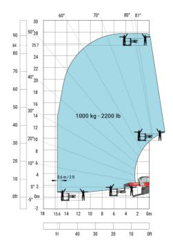
Rotación sobre estabilizadores bajados con 3D positiva Rotación sobre estabilizadores bajados, con 3D
