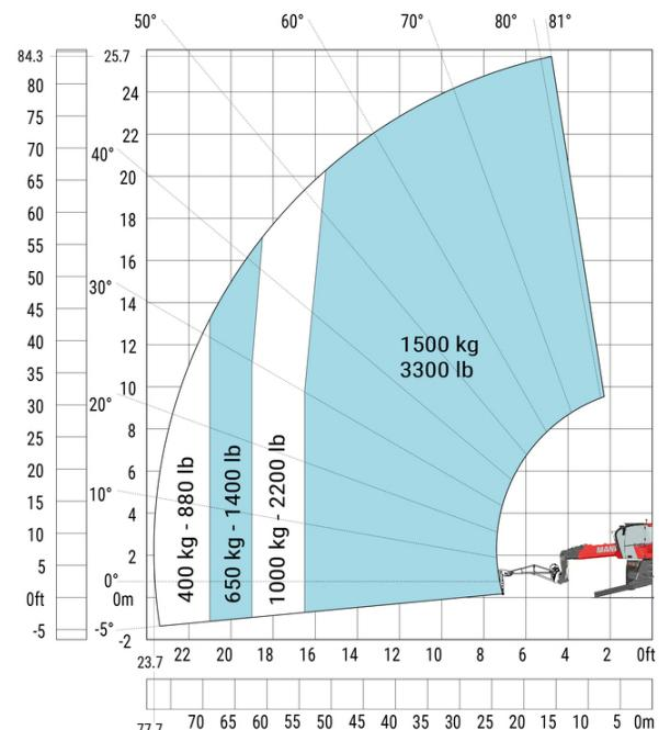
**Macchina su stabilizzatori abbassati con braccio estensibile con verricello (metrico)**
