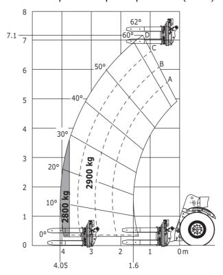
Machine sur pneus avec pince à pneus TH 49 (Métric)
