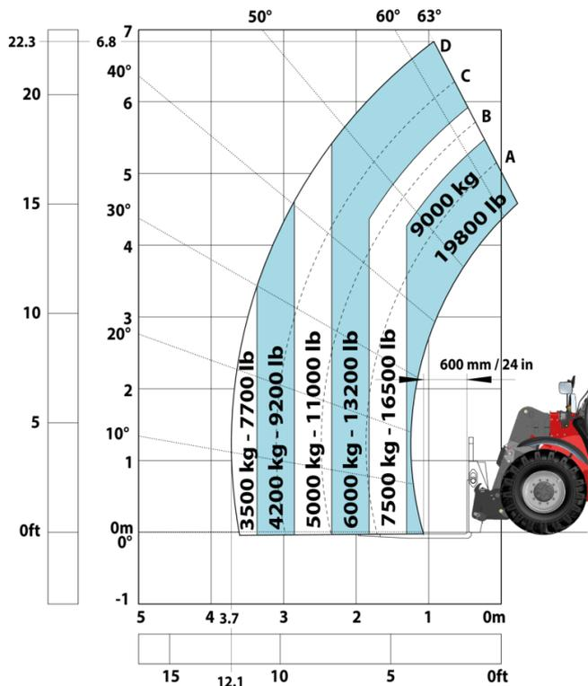
Машина на колесах с лебедкой 9000кг, метрическая система мер
