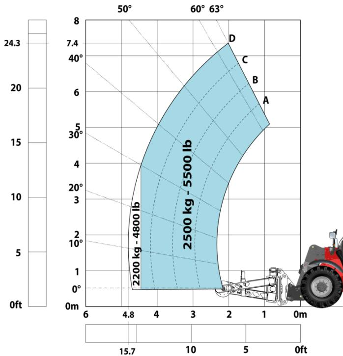
Машина на шинах с захватом для шин TH 35, метрическая система мер
