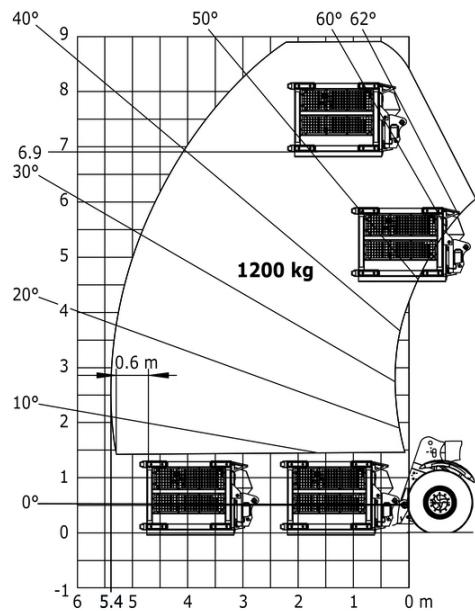
**Машина на колесах с захватом для шин TH 35, метрическая система мер**
