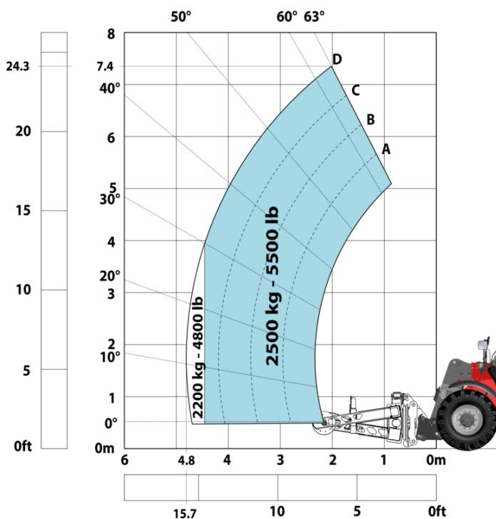
**Машина на колесах с захватом для шин TH 51, метрическая система мер**
