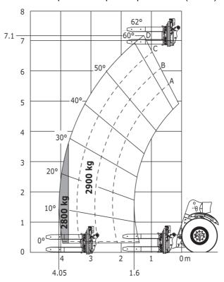
Machine sur pneus avec pince à pneus TH 49 (Métric)
