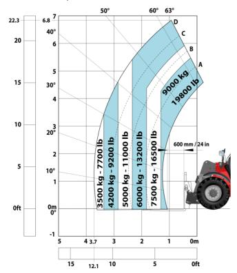
Machine sur pneus avec treuil 9000 kg (Metric)
