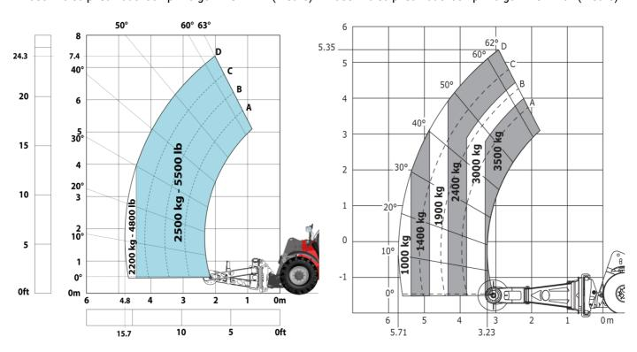
Macchina su pneumatici con pinza cilindri CH 4 (Metric)
