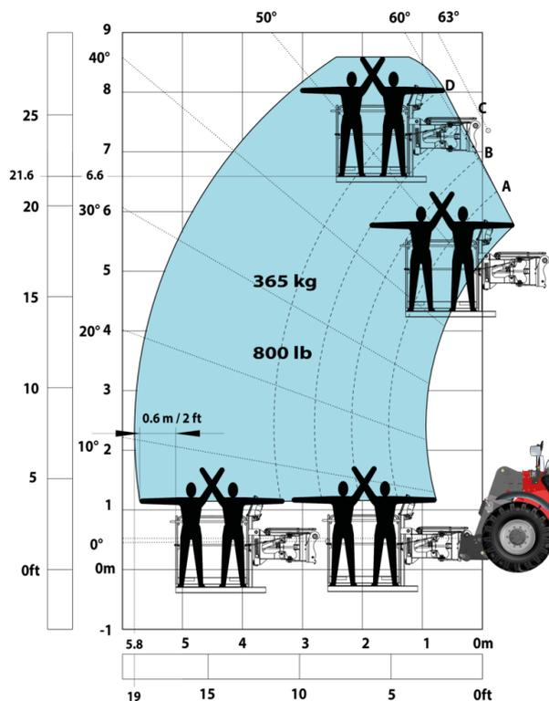
Machine sur pneus avec panier mine (Métric)
