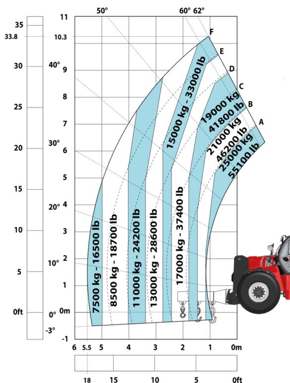
Machine sur pneus avec panier mine (Métric)
