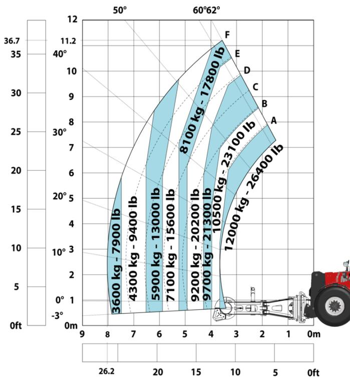
Macchina su pneumatici con pinza cilindri CH 10 (Metric)
