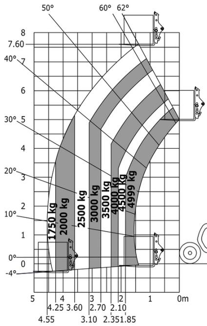
Машина на колесах с вилами LC 600 мм, метрическая система мер
