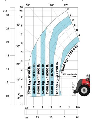
Máquina sobre neumáticos con pluma de ganchos 16000 kg (Métrico)
