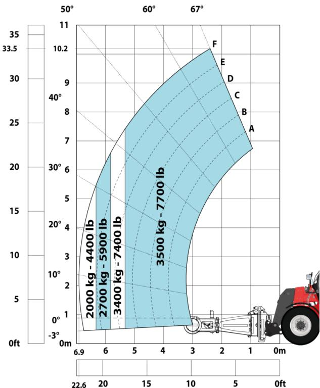
Машина на колесах с захватом для цилиндров СН 4,
