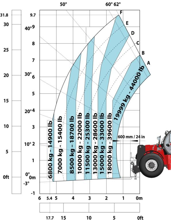
Máquina sobre neumáticos con horquillas LC 1200 mm
