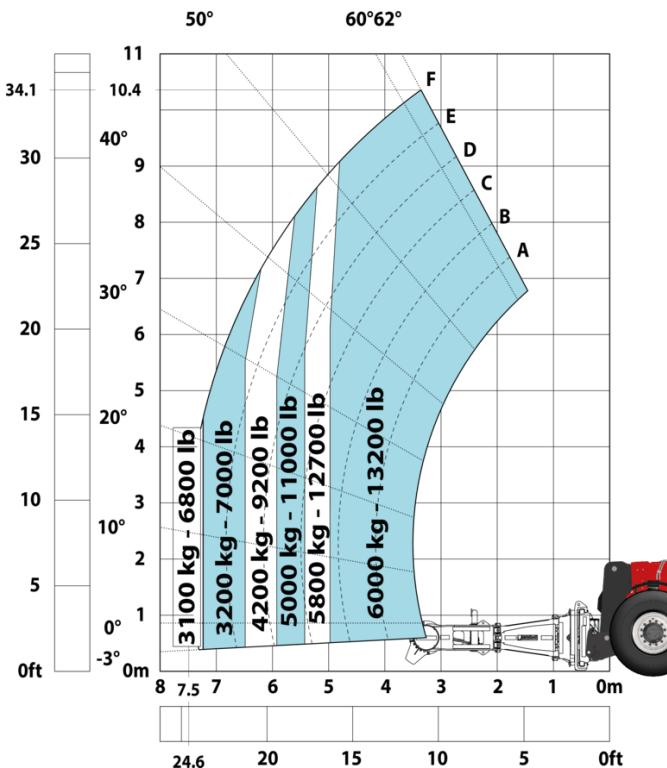
Máquina sobre neumáticos con manipulador de cilindros CH 10 (métrico)
