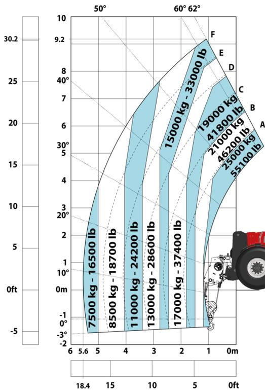
Máquina sobre neumáticos con pluma de ganchos 25000 kg (Métrico)
