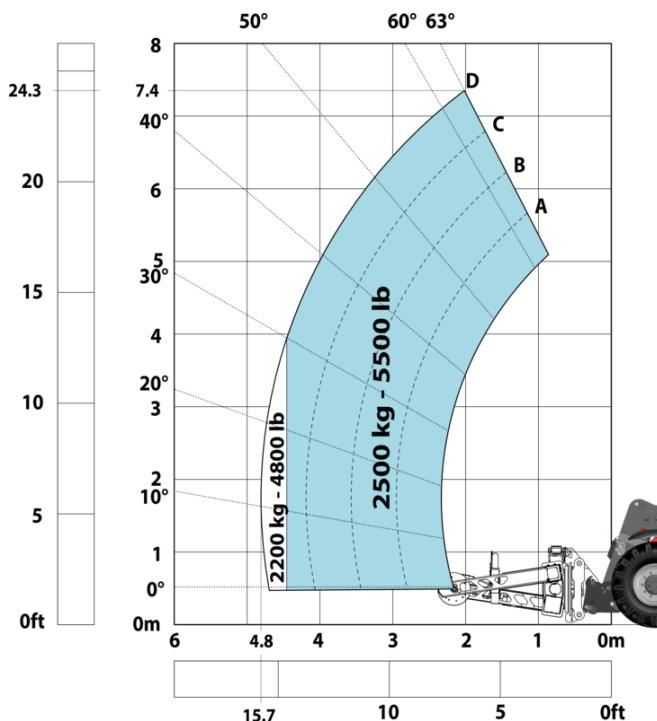
Máquina sobre neumáticos con manipulador de cilindros CH 4 (métrico)
