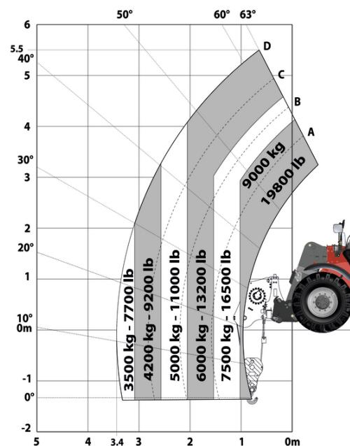
Máquina sobre neumáticos con pluma de ganchos 9000 kg (métrico)
