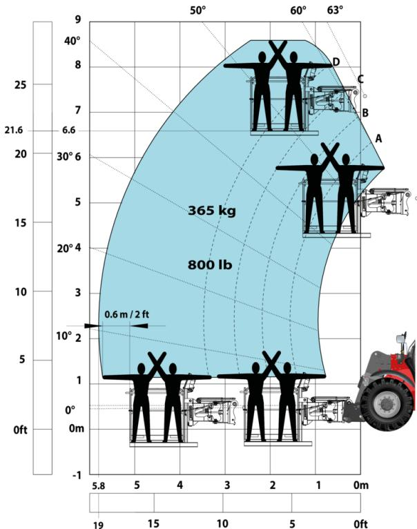
Máquina sobre neumáticos con manipulador de neumáticos TH 49 (Métrico)
