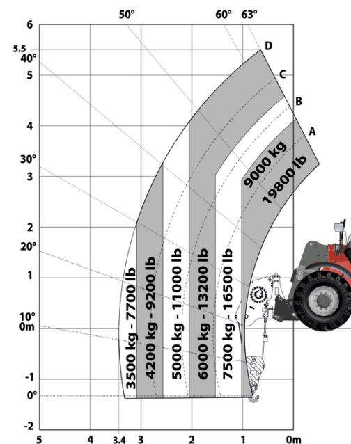
Машина на колесах с краном с 3-мя крюками 9000кг, метрическая система мер
