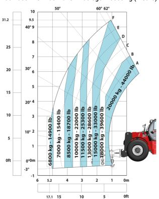
Maschine auf Reifen mit Reifengreifer TH 57 (Metrisch)
