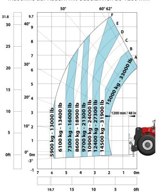
Maschine auf Reifen mit Winde 20000 kg (Metric)
