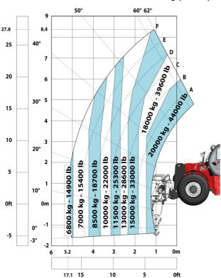
Radmaschine mit 3-Haken-Ausleger 20000 kg (Metric)
