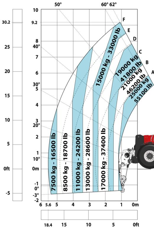
Machine sur pneus avec potence 3 crochets 25000 kg (Metric)
