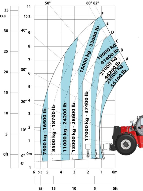
Macchina su pneumatici con pinza gomme TH 63 (Metric) Macchina su pneumatici con pinza cilindri CH 10 (Metric)
