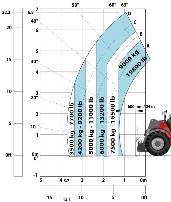
Máquina sobre neumáticos con pluma de ganchos 9000 kg (métrico)
