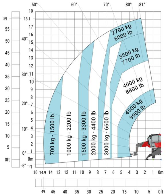
Drehung an abgesenkten Stützen mit 365 kg Arbeitskorb
