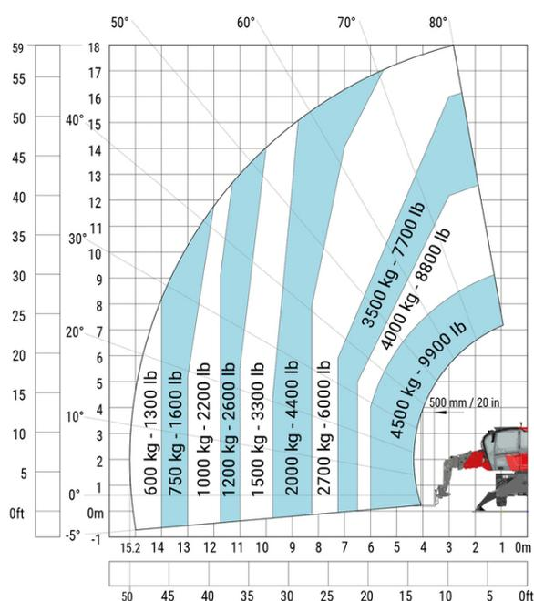
**Drehung mit abgesenkten Stützen mit Seilwinde 5000 kg Maschine auf abgesenkten Stabilisatoren mit 4000 kg Galgen (Metrisch)**
