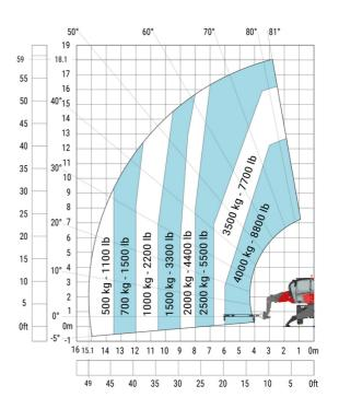
Maschine auf abgesenkten Stabilisatoren mit 1500 kg WindeMaschine auf abgesenkten Stabilisatoren mit Haken 5000 (Metrisch) kg (Metrisch)
