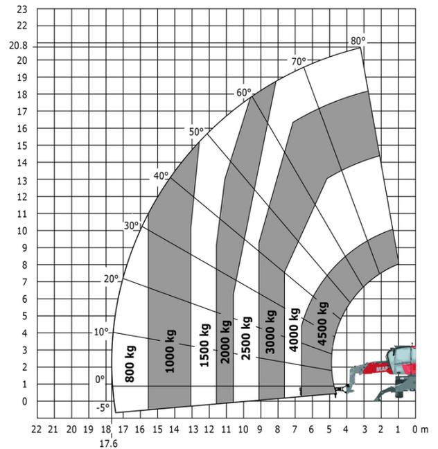
Rotación sobre estabilizadores bajados con plataforma de 365 kg      Rotación sobre estabilizadores bajados, con plataforma de 1.000 kg
