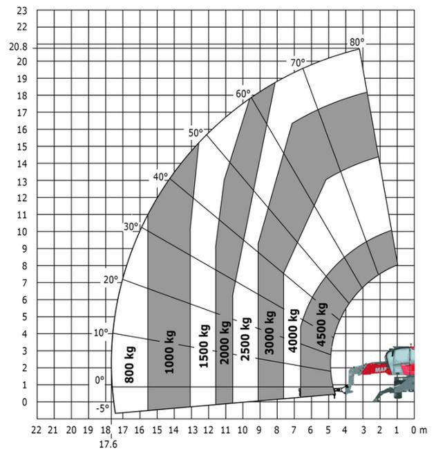
Machine sur stabilisateurs abaissés avec nacelle 365 kg
