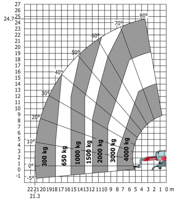
Maschine auf abgesenkten Stabilisatoren mit 1500 kg Winde Maschine auf abgesenkten Stabilisatoren mit Haken 5000 kg (Metrisch)
