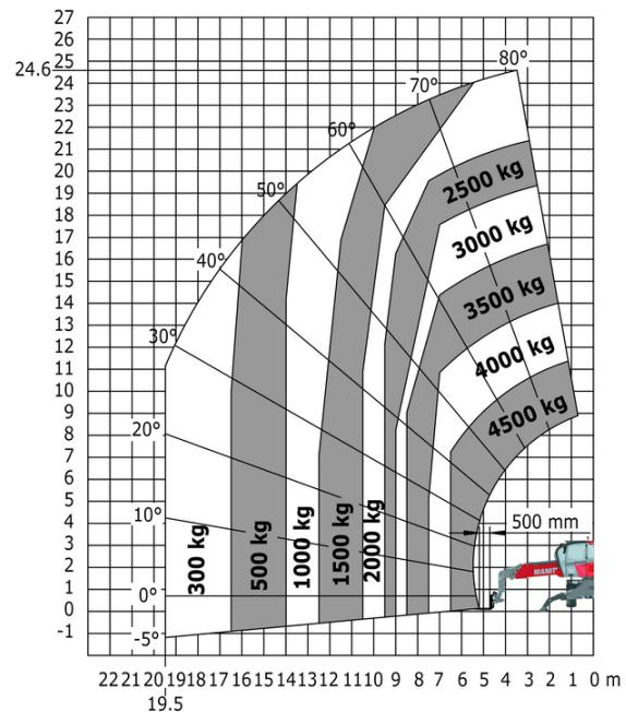
Drehung mit abgesenkten Stützen mit Seilwinde 5000 kg Maschine auf abgesenkten Stabilisatoren mit 4000 kg Galgen (Metrisch)
