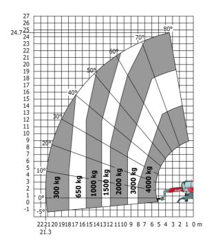
Machine sur stabilisateurs abaissés avec potence-treuil de Machine sur stabilisateurs abaissés avec crochet 5000 kg 1500 kg (Métrique)
