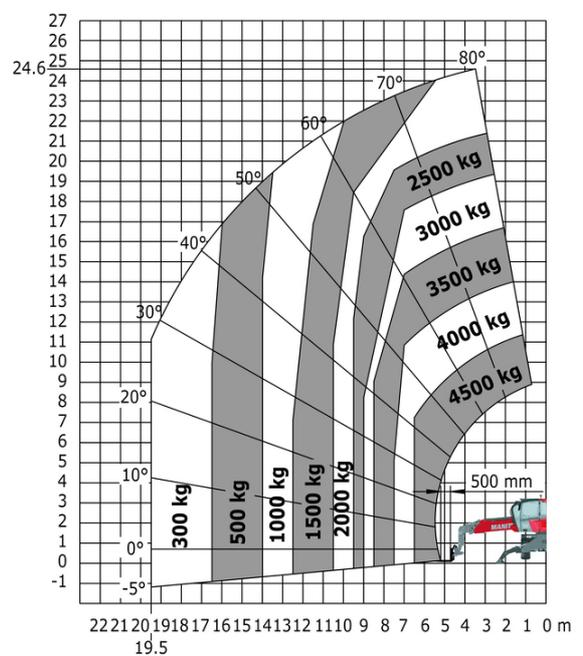
Drehung auf abgesenkten Stützen mit Winde 5000 kg
