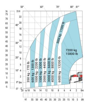
Machine sur stabilisateurs abaissés avec potence 1500 kg Machine sur stabilisateurs abaissés avec potence 2000 kg (Métrique)
