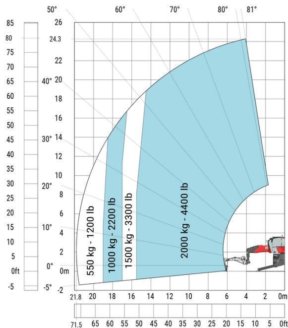
Macchina su stabilizzatori abbassati con braccio estensibile con verricello (metrico)
