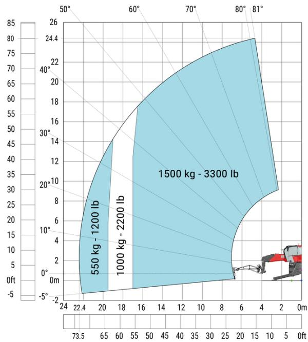
Rotazione su stabilizzatori con braccetto jib da 2000 kg Metrico
