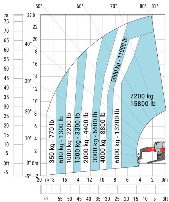
Rotazione su stabilizzatori con braccetto jib da 1500 kg Metrico
