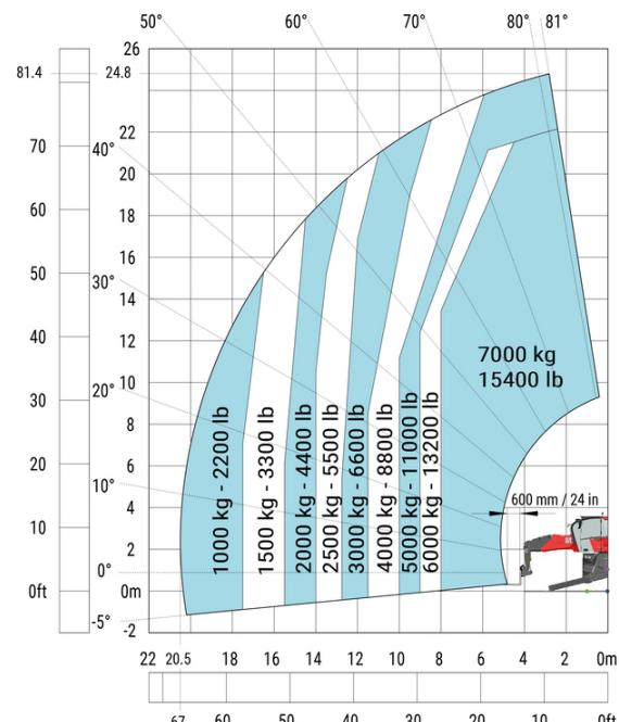
Macchina su stabilizzatori abbassati con verricello 6000 kg Macchina su stabilizzatori abbassati con argano 7200 kg
