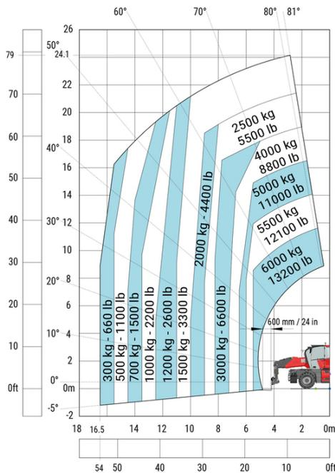
Drehung auf abgesenkten Stützen mit Gabeln
