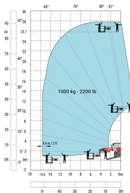
Drehung auf abgesenkten Stützen mit 3D positiv
