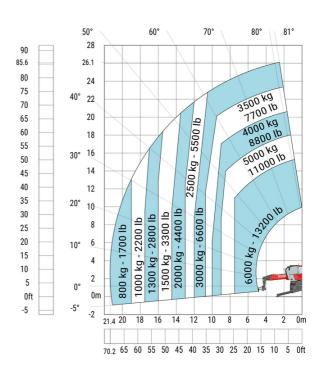
Drehung auf abgesenkten Stützen mit 365 kg-Plattform
