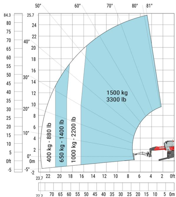
**Maschine auf abgesenkten Stabilisatoren mit ausfahrbarem Windenarm**
