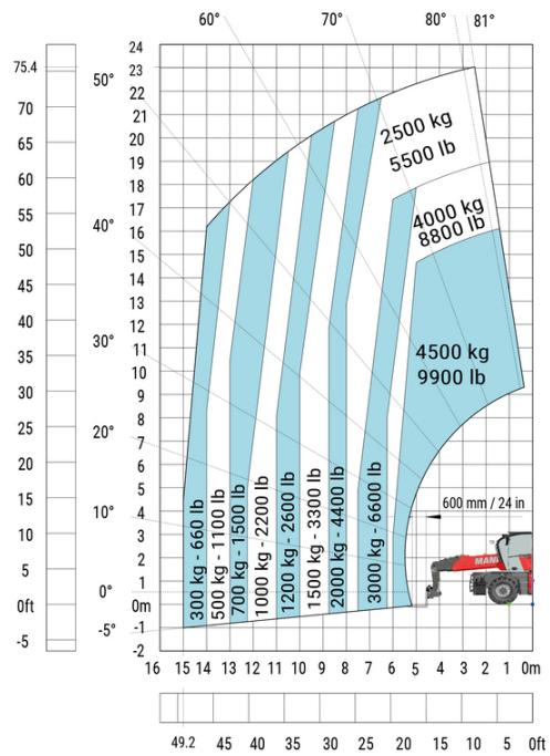
Maschine auf abgesenkten Stabilisatoren mit Gabeln (CAF)
