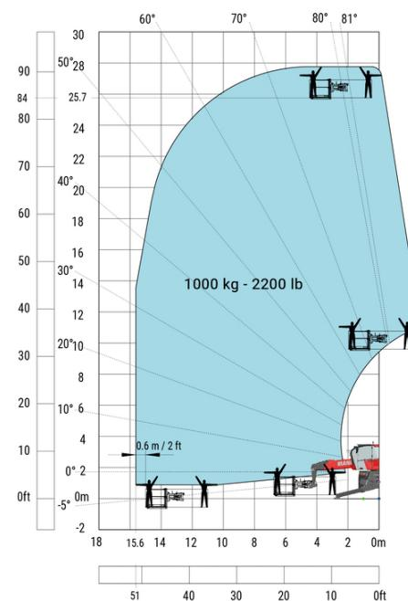
Drehung mit abgesenkten Stützen mit 3D positiv
