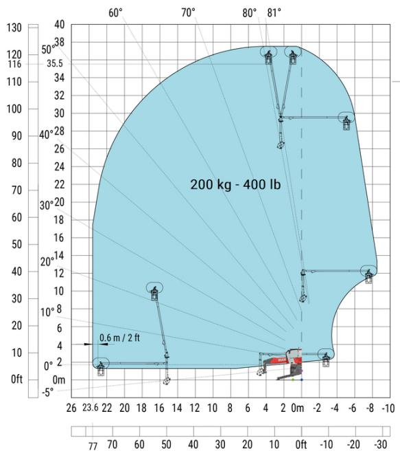
Drehung mit abgesenkten Stützen mit 3D positiv / negativ
