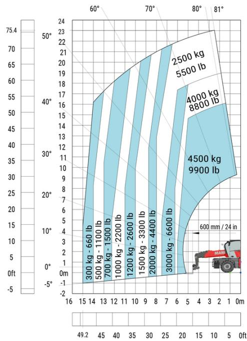
Maschine auf abgesenkten Stabilisatoren mit Gabeln (CAF)
