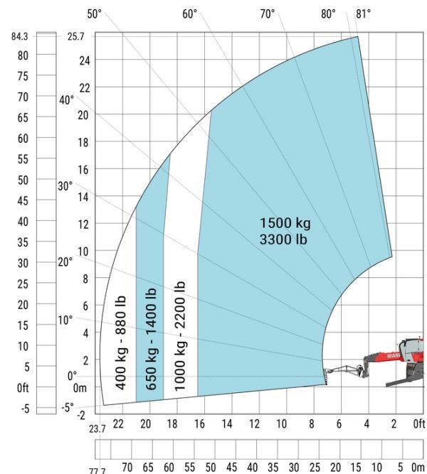
**Maschine auf abgesenkten Stabilisatoren mit ausfahrbarem Windenarm**
