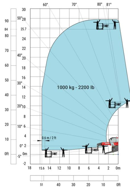
Rotación sobre estabilizadores bajados con 3D positiva      Rotación sobre estabilizadores bajados, con 3D positiva/negativa
