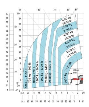
Macchina su stabilizzatori abbassati con verricello 6000 kg Macchina su stabilizzatori abbassati con braccio da 1500 (metrico) kg con verricello (Metrico)
