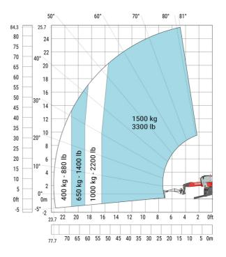
Máquina sobre estabilizadores rebaixados com lança extensível com guincho (Metric)
